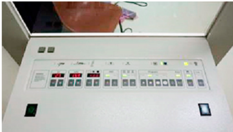
Figura 78. Travas dos movimentos do mamógrafo Fonte: Acervo SQRI.
