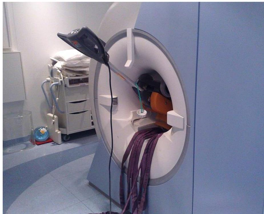
Acidente em um sistema de RM de 1,5T. Uma enceradeira foi atraída pelo campo magnético. Ela só pôde ser removida diminuindo o campo magnético. Visão da parte traseira (fundo do aparelho) de RM. Reproduzido de: [https://commons.wikimedia.org/wiki/File:MRI\\_accident\\_on\\_a\\_1.5\\_Tesla\\_MR\\_system.jpg](https://commons.wikimedia.org/wiki/File:MRI_accident_on_a_1.5_Tesla_MR_system.jpg)
